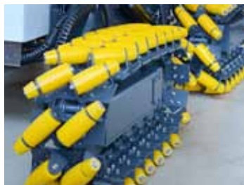
Die tonnenförmigen Walzen sind am Kettenantrieb winklig angebracht.
