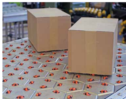
Modularer Aufbau und individuelle Ansteuerung der Räder ermöglichen flexible Sortieraufgaben auf kleinem Raum
